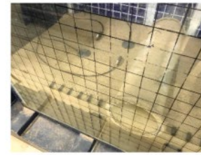
(d) Installation of pressure cells
